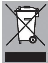
Das Produkt ist mit einem durchgestrichenen Abfallcontainer gekennzeichnet. Mit diesem Symbol wird darauf hingewiesen, dass Haushaltsgeräte separat entsorgt werden müssen. Das Gerät darf am Ende seiner Nutzungsdauer nicht über den normalen Hausmüll entsorgt werden. Geben Sie das Gerät bei einem kommunalen Abfallsammelpunkt oder bei Ihrem Händler ab.
