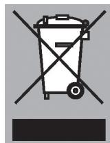
Om op de verplichting tot gescheiden verwerking van elektrische huishoudelijke apparatuur te wijzen, is op het product het symbool van een doorgekruiste vuilnisbak aangebracht. Dit betekent dat het apparaat aan het einde van zijn levensduur niet bij het gewone huisvuil mag worden gevoegd. Het toestel moet naar een speciaal centrum voor gescheiden afvalinzameling van de gemeente worden gebracht of naar een verkooppunt dat deze service verschafft.
