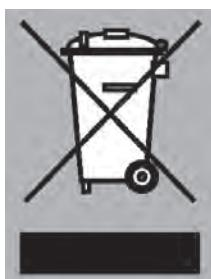
Zur Erinnerung an die Verpflichtung, die Elektrohaushaltsgeräte getrennt zu beseitigen, ist das Produkt mit einer Mülltonne, die durchgestrichen ist, gekennzeichnet. Dies bedeutet das am Ende seiner Nutzzeit das Produkt **nicht** zusammen mit dem Siedlungsabfall beseitigt werden darf. Es kann zu den eigens von den städtischen Behörden eingerichteten Sammelstellen oder zu den Fachhändlern, die einen Rücknahmeservice anbieten, gebracht werden.
