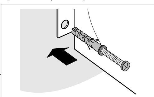
6. Boor de borggaten (2x  $\varnothing$  6 mm). Borg de motormodule met de bijgeleverde kozijnpluggen (6 x 60).
