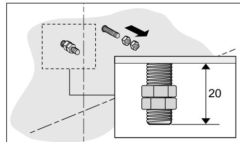
4. Laat 20 mm van de draadeinden uit de muur steken. Verwijder de moeren.
