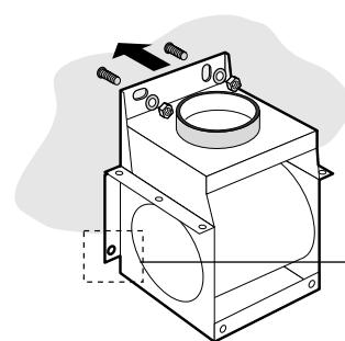
5. Hang de motormodule aan de draadeinden. Draai de moeren aan. Zorg ervoor dat de module exact waterpas hangt.
