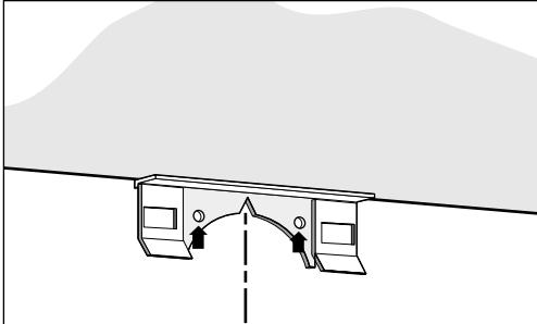
2. Plaats het midden van de bevestigingsbeugel op de hartlijn (tegen het plafond). Markeer en boor de bevestigingsgaten ( $\varnothing$  8 mm).
