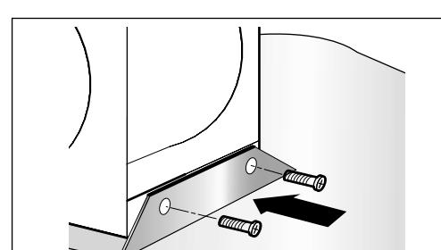
4. Schroef de twee bijgeleverde bouten (M5 x12) in de kap, maar Schroef deze nog niet vast. Stel de kap waterpas en Schroef de kap stevig vast.
