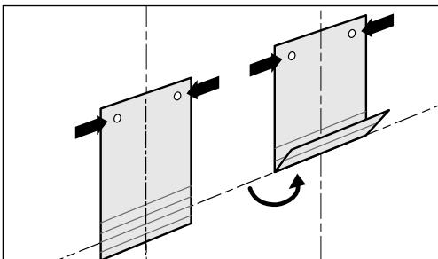
2. Leg de mal volgens type op de lijn (of vouw om op de lijn van de kap), teken de bovenste gaten af en boor de gaten (2x  $\varnothing$  10 mm).
