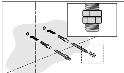
3. Bevestig de pluggen. Draai 2 moeren in tegengestelde richting op de draadeinden. Draai de draadeinden in de muur.
