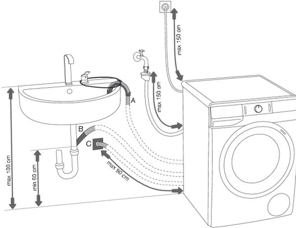
**A** Vous pouvez placer l'extrémité du flexible de vidange sur le rebord d'un évier ou d'un lavabo. Fixez le tuyau à l'aide d'une ficelle que vous passerez dans l'œillet du coude pour éviter qu'il tombe par terre.
