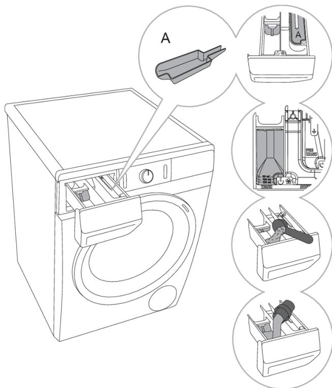
**1** Une cloison mobile est livrée avec le lave-linge ; elle vous permet d'utiliser de la lessive liquide dans le compartiment destiné au lavage
