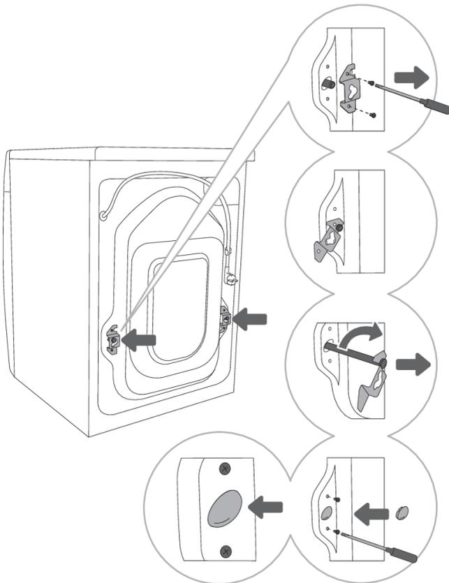
**1** Écartez les tuyaux et retirez les vis à l'arrière de la machine.
