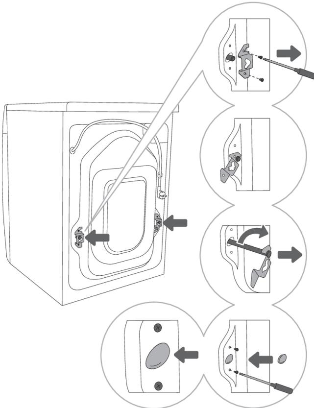
**1** Schieben Sie die Schläuche weg und lösen Sie die Schrauben auf der Rückseite des Geräts. Nehmen Sie beide Eckstücke ab.
