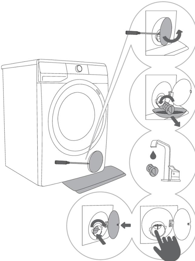
**1** Öffnen Sie die Filterabdeckung mit einem Werkzeug (Schraubenzieher o.Ä.).
