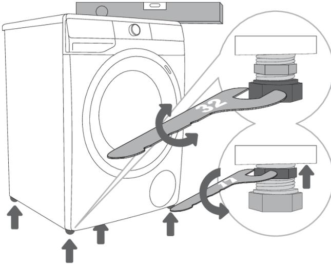
**1** Richten Sie die Maschine durch Verdrehen der verstellbaren Gerätefüße in die waagrechte Stellung aus.
