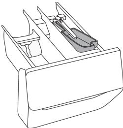
Voeg alleen de door de fabrikant aanbevolen hoeveelheid desinfectiemiddel toe. De aanbevolen trommellading is maximaal 3 kg. Gebruik alleen desinfectiemiddelen die bestemd zijn voor kleding. Het gebruik van andere desinfectiemiddelen kan uw kleding beschadigen (verkleuring, vlekken, enz.).
