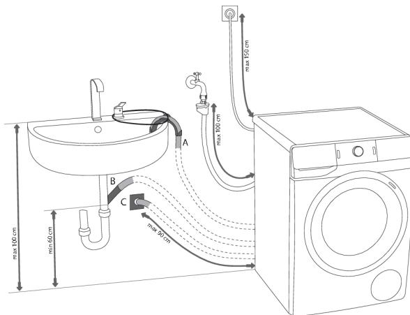
**A** De afvoerslang kan in een gootsteen of badkuip worden geplaatst. Bevestig de slang met een touwtje, zodat deze niet op de grond kan glijden.
