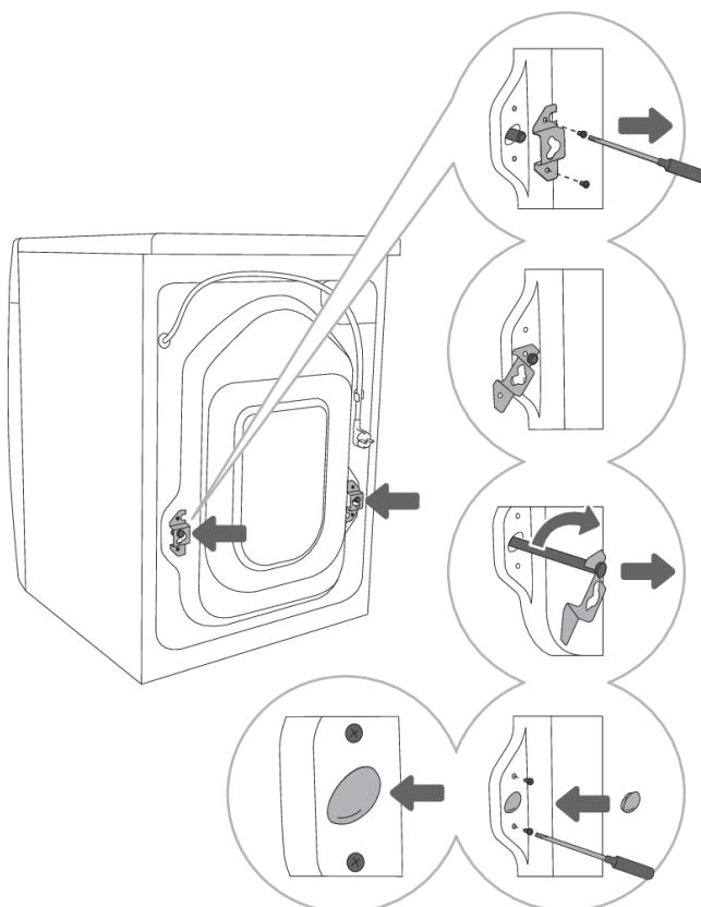
1 Verplaats eventueel de slang en draai de schroeven los aan de achterzijde van de wasmachine.
