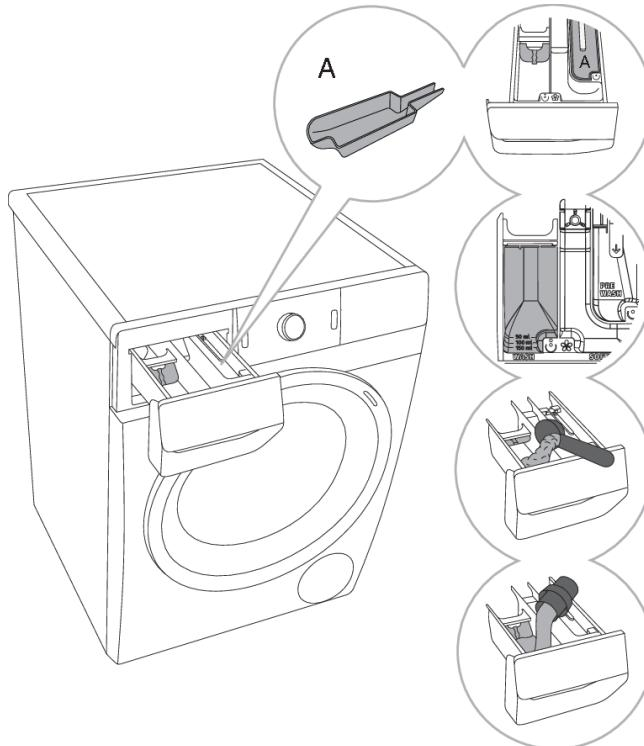
**1** Een separator/verdelerlip wordt bij de wasmachine geleverd, waardoor vloeibaar wasmiddel aan het hoofdwascompartiment kan worden toegevoegd (linker compartiment).
