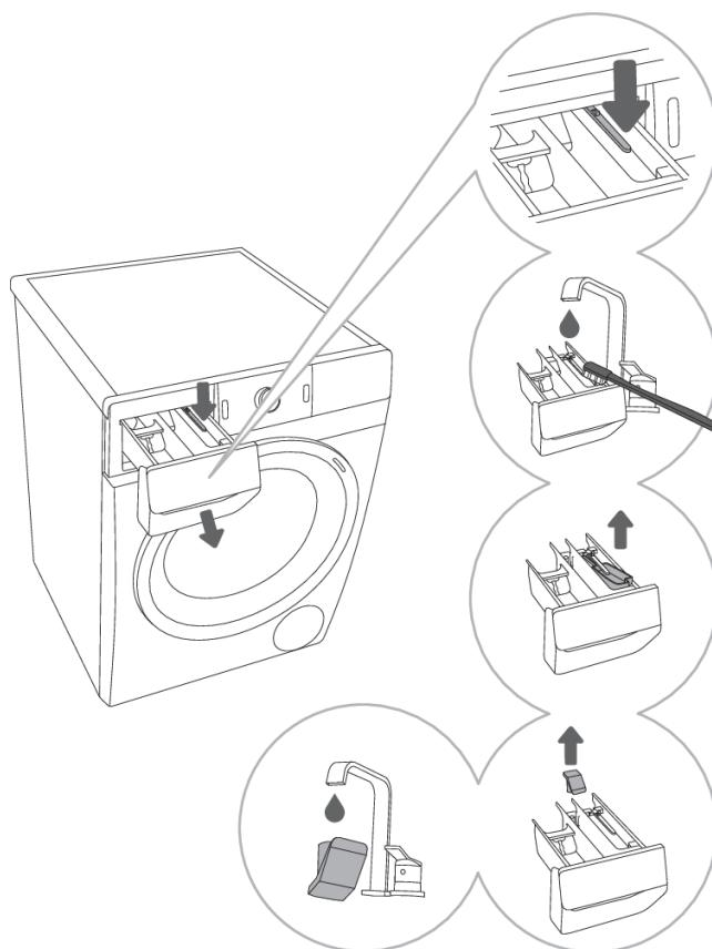
**1** Druk op het kleine lipje om de dispenserlade uit de behuizing te verwijderen.
