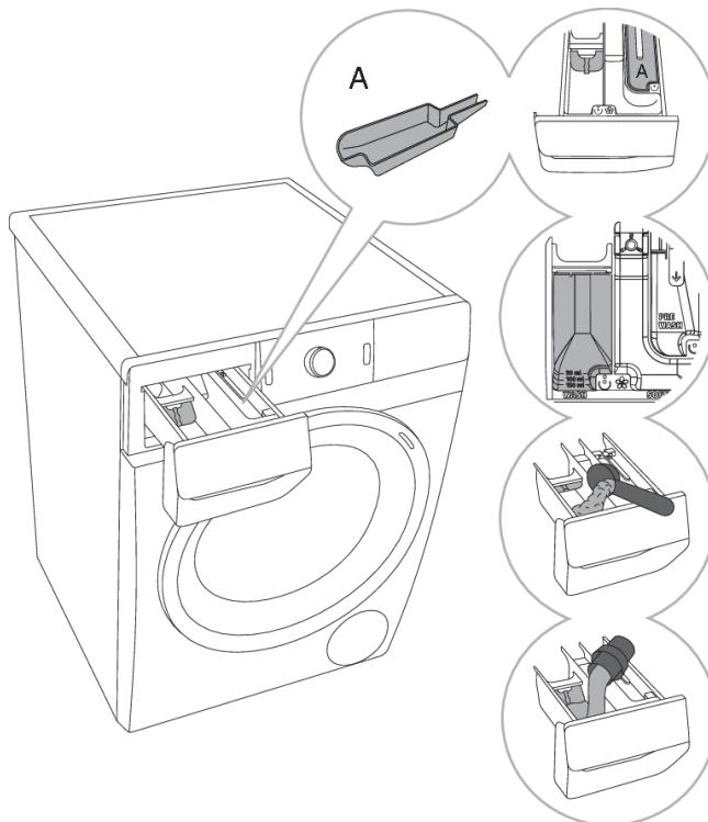
**1** Une cloison mobile est livrée avec le lave-linge ; elle vous permet d'utiliser de la lessive liquide dans le compartiment destiné au
