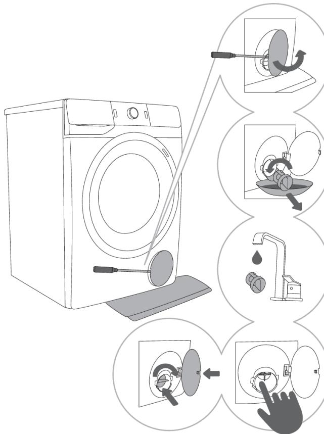
**1** Open de pompfilterdeksel met geschikt gereedschap (platte schroevendraaier of vergelijkbaar gereedschap).
