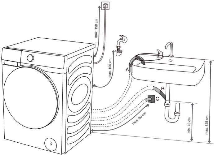
**C** Der Abflussschlauch kann ebenfalls an einem Abfluss mit Siphon befestigt werden, der ordnungsgemäß installiert sein muss, um eine Reinigung zu ermöglichen.
