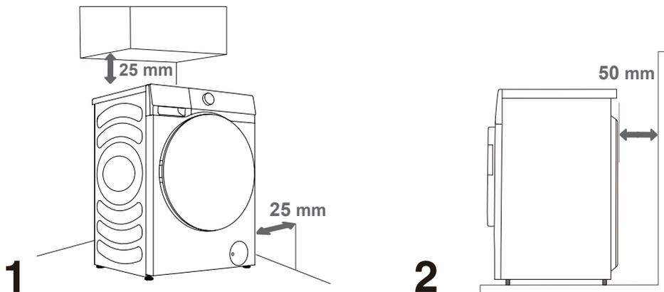
⚠ Die Waschmaschine darf nicht mit einer Wand oder einem Möbelstück in Berührung kommen. Um einen optimalen Betrieb zu gewährleisten, lassen Sie um die Waschmaschine herum etwas Platz, wie in der Abbildung angegeben.
