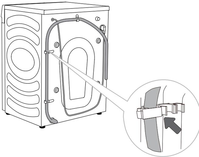
**D** Der Abflussschlauch muss an den Haken auf der Rückseite der Waschmaschine befestigt werden, wie in der Abbildung gezeigt.
