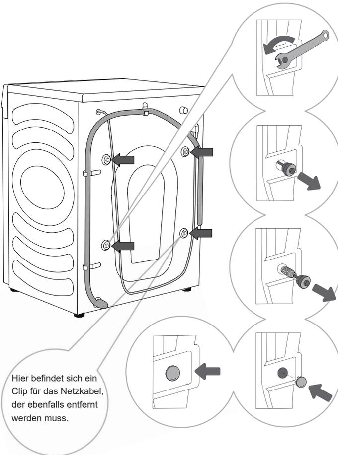
**1** Schieben Sie die Schläuche beiseite und verwenden Sie einen passenden Schraubenschlüssel, um die 4 Bolzen auf der Rückseite gegen den Uhrzeigersinn zu lösen, wie durch den Pfeil angezeigt. Lösen Sie sie um etwa 30 mm (nicht vollständig).
