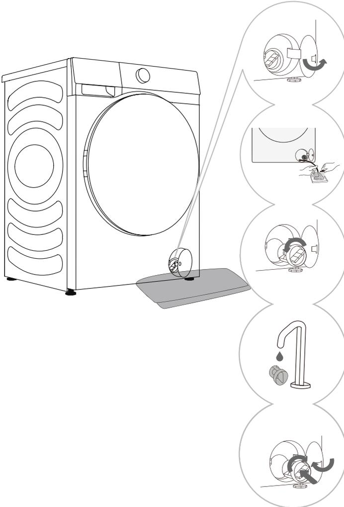
**1** Öffnen Sie die Klappe des Pumpenfilters (drücken Sie auf die Klappe, damit sie springt auf).
