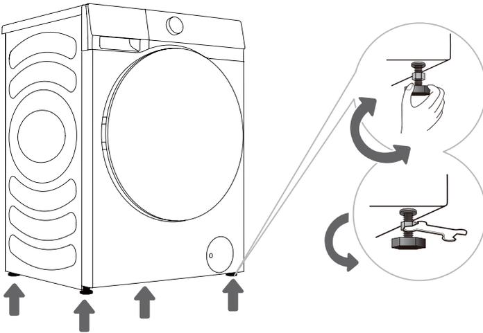
**1** Drehen Sie die Einstellfüße, um die Maschine zu nivellieren. Die Füße ermöglichen eine Nivellierung um  $\pm 2$  cm.
