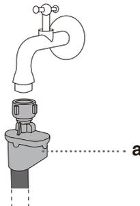
☛ Tauchen Sie den Wasserzulaufschlauch mit dem AquaStop-System nicht in Wasser ein, da er ein elektrisches Ventil enthält.
