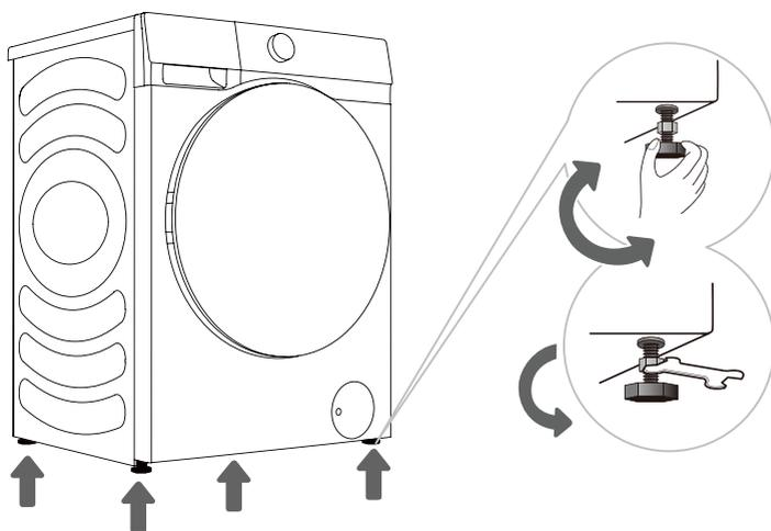
**1** Faire tourner les pieds réglables pour mettre le lave-linge à niveau longitudinalement et transversalement. Les pieds permettent une mise à niveau de +/- 2 cm.
