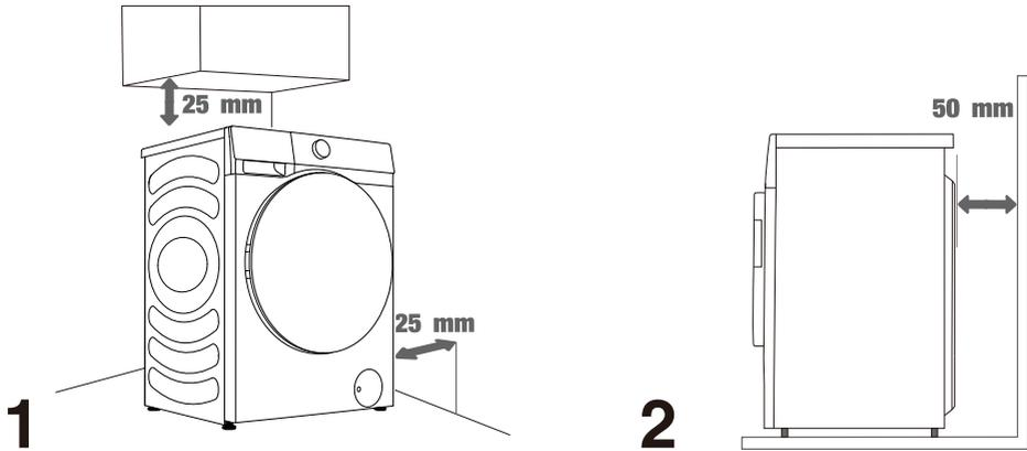
☼ Le lave-linge ne doit pas être en contact avec un mur ou un meuble adjacent. Pour un fonctionnement optimal du lave-linge, il est recommandé de respecter les dégagements par rapport aux murs comme indiqué sur la figure.
