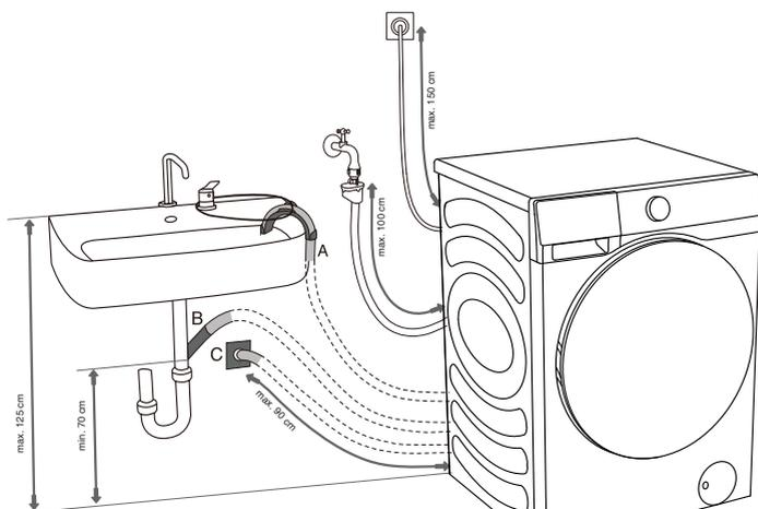
**A** L'extrémité du tuyau d'évacuation peut être placée sur un évier ou une baignoire. B Utiliser une ficelle introduite à travers l'ouverture du support de coude pour fixer le tuyau et l'empêcher de glisser sur le plancher.
