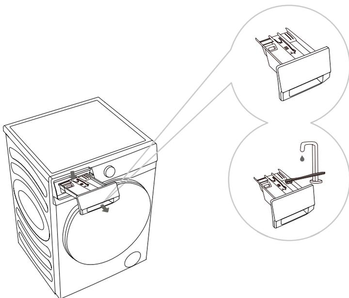
**1** Pour retirer le compartiment à détergent du boîtier, appuyez sur la petite languette.
