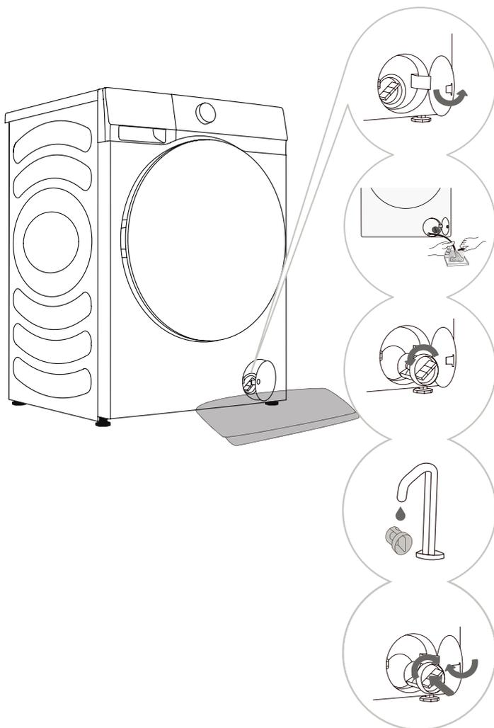
**1** Ouvrez le bouchon du filtre de la pompe (appuyez sur le couvercle du hublot et le bouchon s'ouvre).
