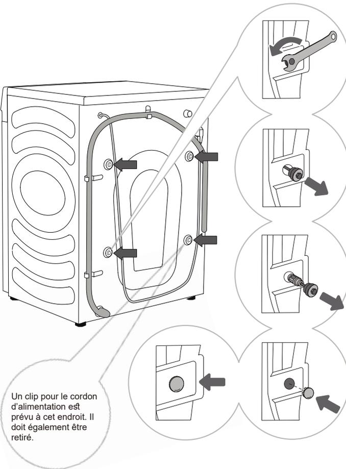
Un clip pour le cordon d'alimentation est prévu à cet endroit. Il doit également être retiré.
