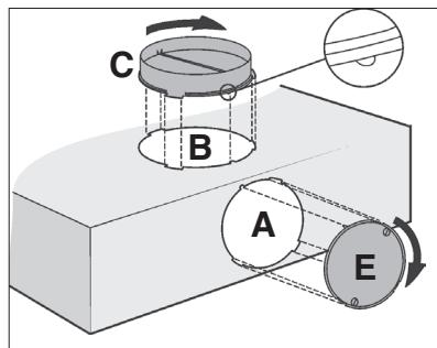
2. Sluit de afvoerpijp aan op de flens (C).
