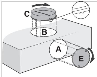
2. Schließen Sie das Abluftrohr an den Flansch (C) an.
