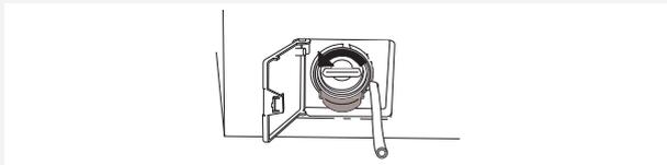
4. Öffnen Sie die Pumpe, indem Sie den Deckel gegen den Uhrzeigersinn drehen. Entfernen Sie den Deckel mit dem Sieb.
