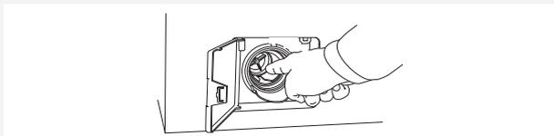
6. Schrauben Sie den Deckel wieder auf, befestigen Sie den Ablaufschlauch am Haken und schließen Sie die Abdeckung.
