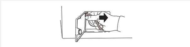
3. Lassen Sie das Wasser in eine Schüssel ablaufen, indem Sie den Ablaufschlauch vom Haken in der Abdeckung nehmen.
