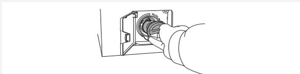
5. Entfernen Sie alle Gegenstände aus dem Pumpengehäuse. Prüfen Sie, ob die Pumpenflügel auf der Rückseite rotieren.
