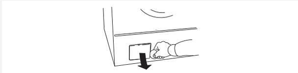
2. Öffnen Sie die Abdeckung unten links zur Abflusspumpe, wie im Bild gezeigt.
