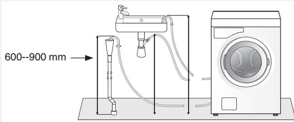
Der Waschautomat kann auch mit einer Muffe an den Abfluss angeschlossen werden. Auch in diesem Fall sollte der Schlauch 600 - 900 mm über dem Boden angebracht sein. Der Innendurchmesser des Anschlusses sollte mindestens 18 mm betragen.
