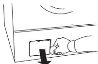
2. Öffnen Sie die Abdeckung unten links zur Abflusspumpe, wie im Bild gezeigt.
