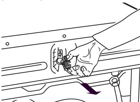
3. Retirer les couvercles en plastique des bouchons. Pousser les couvercles en plastique dans les trois orifices ayant contenu les bouchons. Conserver les bouchons en plastique en vue d'un déplacement ultérieur de la machine.
