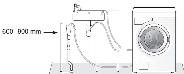
La machine peut également être raccordée à l'évacuation à l'aide d'un ergot. Dans ce cas, la hauteur du flexible doit également être de 600 à 900 mm (24" à 36"). Le diamètre interne du flexible doit être au minimum de 18 mm (0,7").
