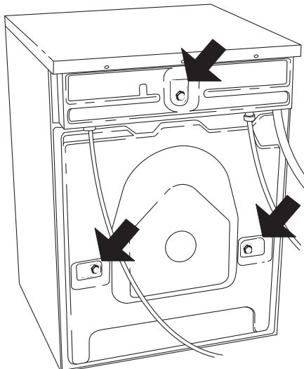
1. Desserrer et retirer les boulons (voir le schéma ci-après).
