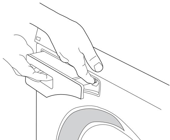
Lorsque la fermeture de sécurité est activée, il faut appuyer sur le bouton de libération pour sortir le compartiment à détergent.
