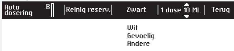
Als u het wasmiddel in reservoir B vervangt, kiest u ook een ander soort wasgoed. Op het display verschijnt de vraag of u echt het wasmiddel wilt vervangen.
