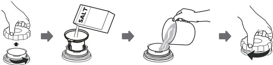
1. Nehmen Sie den Unterkorb heraus und schrauben Sie den Deckel des Behälters auf.
