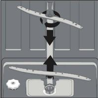
Die Sprüharme müssen regelmäßig gereinigt werden. Verschmutzung verstopft auf Dauer die Sprühhöpfe und die Lager der Sprüharme. Reinigen Sie die Sprüharme folgendermaßen:
