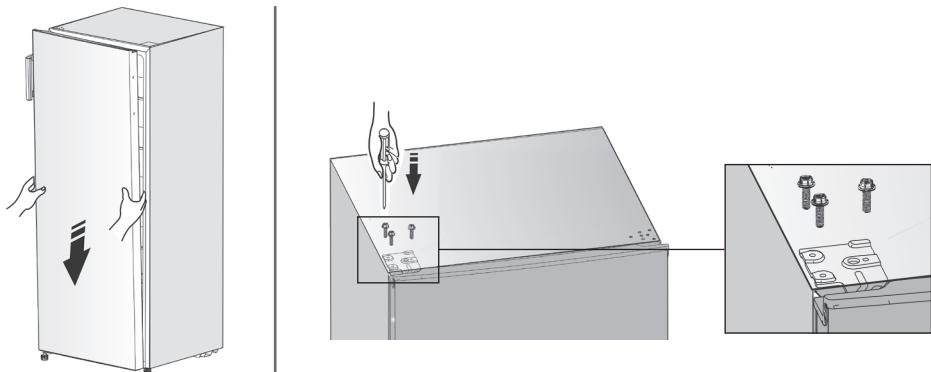
8. Setzen Sie die Abdeckplatten auf (verwenden Sie die mitgelieferte linke Scharnierabdeckplatte).
