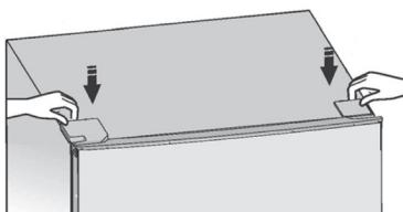
9. Vérifiez que la porte est alignée horizontalement et verticalement et que les joints sont fermés de tous les côtés avant de serrer définitivement la charnière inférieure. Mettez l'appareil à niveau à l'aide des pieds réglables.
