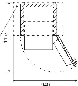
**Stellen Sie sicher, dass um das Gerät herum genügend Platz vorhanden ist, damit eine gute Belüftung und Luftströmung um das Gerät herum möglich ist.**
