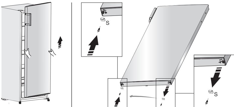
5. Desserrez le pied réglable et la charnière inférieure et fixez-les de l'autre côté.
