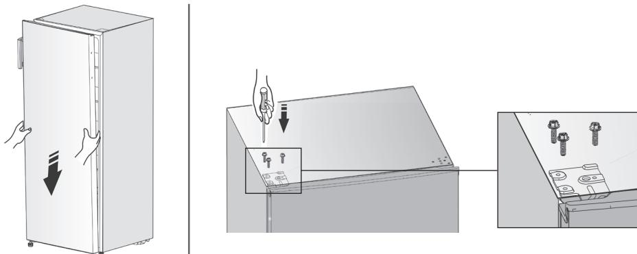
8. Plaats de afdekplaatjes terug (gebruik het bijgeleverde afdekkapje voor het linker scharnier).
