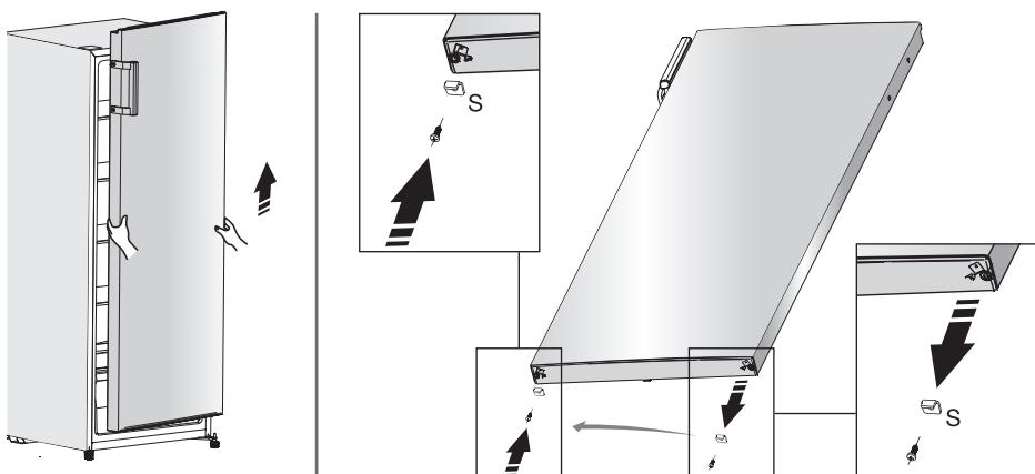
5. Lösen Sie die Stellfüße und das untere Scharnier und befestigen Sie beides an der anderen Seite.
