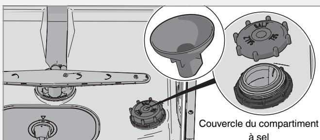
Lorsque la quantité de sel est insuffisante, dévissez le bouchon et remplissez le réservoir de sel. L'eau ne doit être ajoutée que la première fois ! Essuyez l'excédent et serrez. Lancez un programme afin de rincer tout résidu de sel présent dans le lave-vaisselle.
