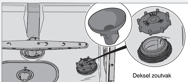
Wanneer het zout bijna op is, schroeft u de dop open en vult u het zoutvak met zout. Alleen de eerste maal is water nodig! Veeg schoon en draai dicht. Draai een programma om ervoor te zorgen dat al het eventuele zout uit de vaatwasser wordt gespoeld.
