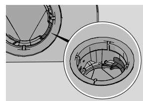
Sicherstellen, dass der farbige Deckel rechts vom Bodenablauf vorhanden ist.
