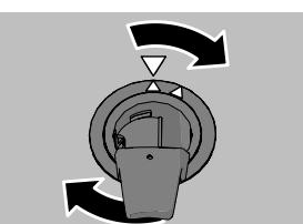
L'efficacité du lave-vaisselle peut être affectée si les filtres ne sont pas mis en place correctement. Veuillez noter que le lave-vaisselle ne doit pas être utilisé sans les filtres !
