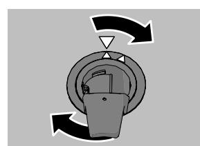
Sind die Filter nicht korrekt eingesetzt, kann dies das Spülergebnis beeinträchtigen. Hinweis: Der Geschirrspüler darf nicht ohne eingesetzte Filter verwendet werden!
