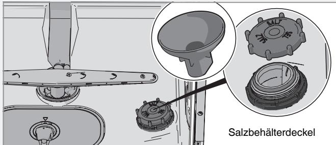
Wenn nicht mehr genügend Salz vorhanden ist, schrauben Sie den Deckel ab und füllen Sie den Behälter mit Salz. Wasser wird nur beim ersten Mal hinzugefügt! Entfernen Sie Rückstände und verschließen Sie den Deckel. Starten Sie ein Programm, so dass sämtliche Salzreste im Geschirrspüler weggespült werden.
