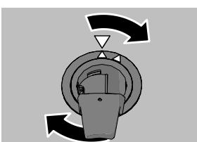
Wasresultaten kunnen slechter zijn als de filters niet correct zijn geplaatst. Let er op dat de vaatwasser niet gebruikt mag worden zonder dat de filters geplaatst zijn!
