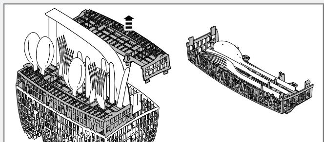
Het deksel van de bestekkorf kan worden verwijderd en bijvoorbeeld als een extra bestekkorf in de bovenste korf worden gebruikt (zie onderstaand).
