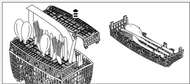
Der Besteckkorb-Deckel kann entfernt und beispielsweise als zusätzlicher Besteckkorb im oberen Korb verwendet werden (siehe unten).
