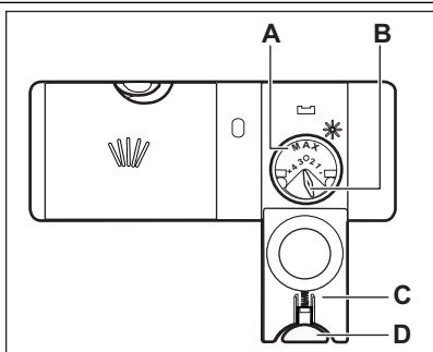
1. Druk op de ontgrendelknop (**D**) om het deksel (**C**) te openen.
