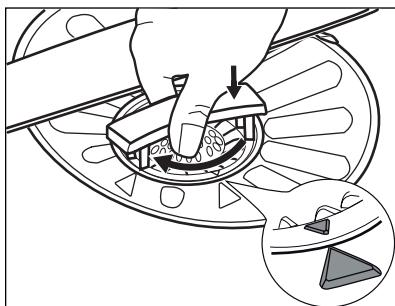
1. Draai het filter (**A**) linksom en verwijder het.
