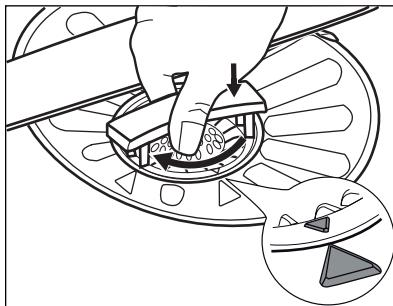
6. Bauen Sie den Filter (**A**) zusammen und setzen Sie ihn in Filter (**B**) ein. Drehen Sie ihn nach rechts, bis er einrastet.
