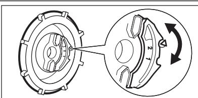
Stellen Sie den Wasserhärtestufen-Wähler auf Stufe 1 oder 2.
