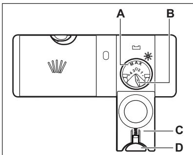
1. Drücken Sie die Entriegelungstaste (**D**), um den Deckel (**C**) zu öffnen.
