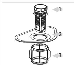
1. Großes Sieb; Essensreste und Schmutz, die auf dieses Sieb gelangen, werden durch einen speziellen Strahl am untersten Sprüharm zum groben Sieb gespült.
