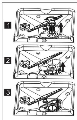
Für eine optimale Funktion der Geschirrspülmaschine muss die Filtergruppe gereinigt werden. Die Filtergruppe holt auf effiziente Weise Essensreste aus dem Wasser und sorgt dafür, dass das Spülwasser während des Programms zirkulieren kann. Entfernen Sie nach der Maschinennutzung die Essensreste aus der Filtergruppe, indem Sie das halbrunde Sieb und Filtergehäuse unter fließendem Wasser reinigen.
