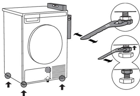
Installez le sèche-linge de façon à ce qu'il soit stable. Utilisez un niveau à bulles pour mettre l'appareil à niveau dans le sens longitudinal et le sens transversal en tournant les pieds réglables avec une clé plate de 22 mm (ajustement en hauteur de 15 mm au maximum). Puis serrez fermement les contre-écrous avec une clé plate de 17 mm en les tournant vers le fond du lave-linge ↑.
