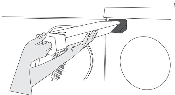
Si vous n'avez pas raccordé la machine à une évacuation distincte, le réservoir d'eau de condensation doit être vidé après chaque charge. Retirez le réservoir, videz-le et remettez-le en place.
