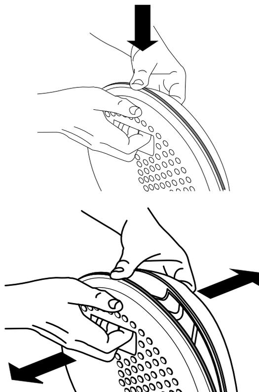
3. Retirez les peluches du filtre à l'aide d'un chiffon doux ou à la main. Si besoin, utilisez une éponge humide et une petite quantité de liquide vaisselle pour éliminer les dépôts. Séchez soigneusement le filtre avec une serviette.
