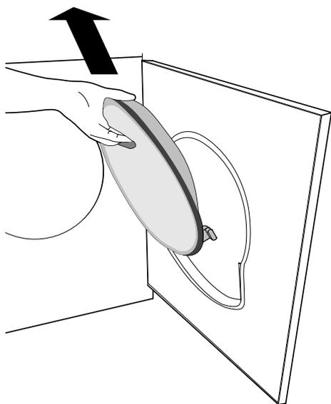
2. Ouvrez le filtre à peluches. Retirez le filtre en appuyant sur le côté avec votre pouce comme le montre le schéma.
