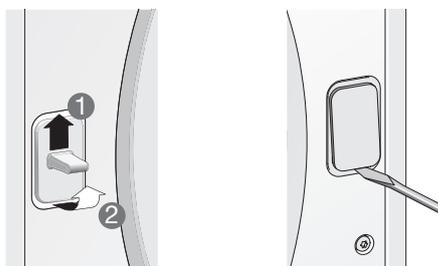
6. Déplacer les bouchons en plastique situés sur les bords supérieur et inférieur de la porte. Utiliser un tournevis à lame plate pour retirer les bouchons.
