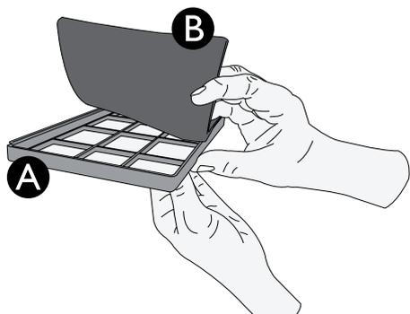
6. Retirer le filtre en mousse (B) situé derrière le filtre en filet. Nettoyer le filtre en mousse dans un lave-linge à l'aide d'un programme de rinçage ou de lavage rapide. Il n'est pas nécessaire d'utiliser du détergent ou de l'eau chaude. Les peluches sont éliminées et le filtre n'est pas endommagé.
