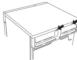
3. Sichern Sie den Kippschutz mit den beiden Schrauben, wie auf dem Bild gezeigt.
