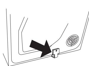
2. Desaperte os dois parafusos indicados na parte de trás da máquina de lavar roupa.
