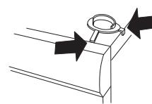
6. Potisnite sušilicu pod metalne nosače. Istovremeno držite prednji rub podignut za 10 mm do 20 mm.
