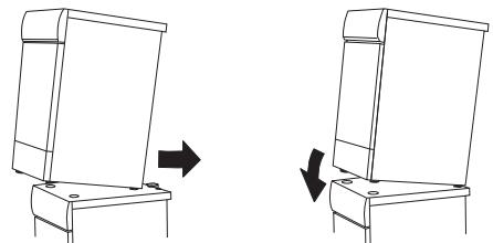
7. Senken Sie nun die Vorderseite des Trockners so ab, dass dessen Füße genau in die Fußuntersetzer auf dem Waschautomaten passen und justieren Sie die Füße, um den Trockner auszubalancieren.
