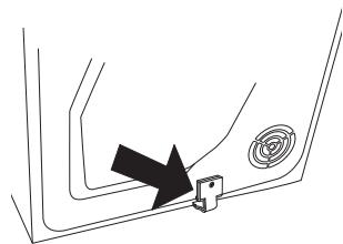
2. Draai de twee schroeven los zoals wordt aangegeven op de achterkant van de wasmachine.
