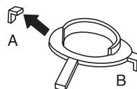
5. Passa in plastkopparna så att de "taggar" som markeras med pilar ligger mot lockets framkant, respektive sidokant och tryck fast dem på locket. Bryt därefter bort resterande taggar.
