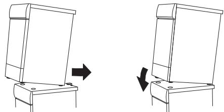
7. Abbassare i piedini anteriori dell'asciugatrice nelle coppette in plastica e sistemare l'asciugatrice per assicurarsi che sia orizzontale.
