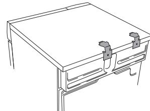
4. På vaskemaskinens topdæksel fastgøres de plastkopper, der skal fiksere tørretumblerens forfødder. Dette er vigtigt, for det er først, når tumblerenens fødder står i plastkopperne, at man ved, at tumbleren er korrekt placeret på vaskemaskinen. Fjern tap A på den kop, der monteres på højre side, og fjern tap B på den kop, der monteres på venstre side. Fjern derefter papiret fra den selvklæbende flade under plastkopperne.
