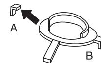
5. Posicione os suportes de plástico de forma que as „abas“ marcadas com setas encostem na borda frontal ou lateral da tampa e pressione-os firmemente contra a tampa. Remova as abas restantes.
