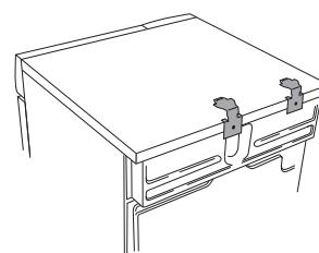
4. Verwenden Sie die Fußuntersetzer, um die Füße des Trockners am Waschautomaten zu befestigen. Nur so können Sie den Trockner in der richtigen Position auf den Waschautomaten stellen.
