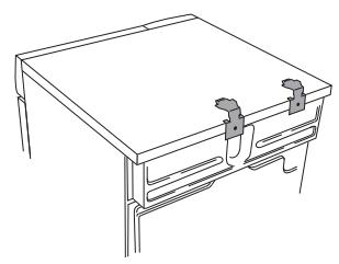
4. Plak de plastic cups ten behoeve van de voorste voetjes van de wasdroger op de bovenplaat van de wasmachine. Dit is belangrijk, want u weet pas zeker dat de wasdroger correct op de wasmachine is geplaatst als de voetjes van de wasdroger in de plastic cups zitten. Breek lipjes A en B af die respectievelijk links en rechts zijn gemonteerd. Verwijder vervolgens het papier van de zelfklevende onderkant van de plastic cups.
