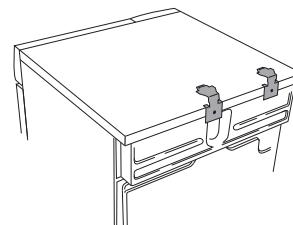
4. De to plastkoppene er beregnet for føttene foran på tørketrommelen og skal festes til topplokket på vaskemaskinen. Dette er viktig, først når trommelføttene står i plastkoppene, vet du at tømmelen er riktig plassert på vaskemaskinen.
