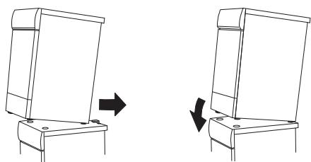
7. Aseta kuivausrummun etujalat muovikuppeihin ja säädä jalat niin, että kuivausrumpu on vaakasuorassa.
