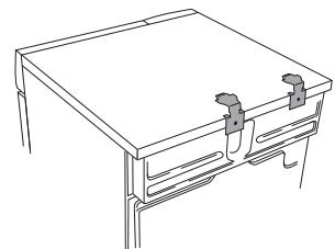
4. På tvättmaskinens topplock fästs de plastkoppar som ska fixera torktumlarens framfötter. Detta är viktigt, för först när tumlarens fötter står i plastkopparna vet man att tumlaren är rätt placerad på tvättmaskinen.
