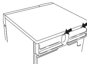
3. Prenda o dispositivo anti-inclinação utilizando os parafusos conforme ilustrado na figura.
