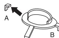
5. Justér plastkopperne, så de "tapper", der er vist med pile, ligger mod topdækslets forkant hhv. sidekant, og tryk dem fast på topdækslet. Fjern derefter de resterende tapper
