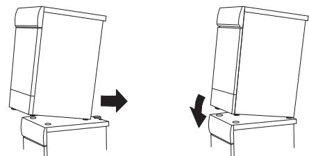
7. Baixe os pés dianteiros da máquina de secar roupa para dentro dos suportes de plástico e ajuste a máquina de secar roupa de forma que fique equilibrada.
