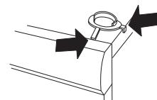
6. Stellen Sie den Trockner so auf den Waschautomaten, dass der zuvor am Waschautomaten befestigte Kippschutz in die eben geöffneten Löcher an der Rückseite des Trockners greift. Halten Sie dazu die Vorderseite des Trockners zunächst um etwa 10 mm bis 20 mm angehoben.
