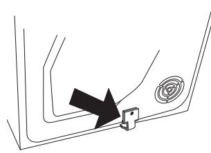
2. Skruva bort de två markerade skruvorna på tvättmaskinens baksida.
