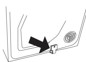
2. Lösen Sie die beiden angezeigten Schrauben auf der Rückseite der Maschine.
