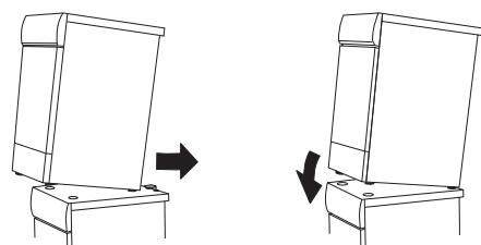
7. Sett beina foran på tømmelen ned i plastkoppene, og juster slik at tømmelen står vannrett.
