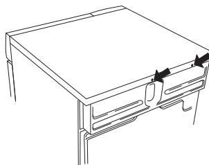
3. Fissare il dispositivo anti-ribaltamento per mezzo delle viti, come illustrato in figura.
