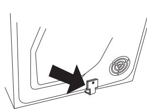
2. Skru av de to avmerkede skruene på baksiden av vaskemaskinen.
