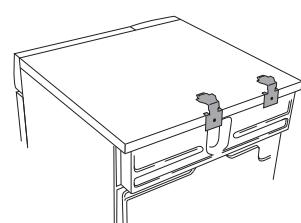
4. Prenda os suportes de plástico para fixar os pés dianteiros da máquina de secar roupa na tampa superior da máquina de lavar roupa. Isto é essencial, pois só com os pés da máquina de secar roupa apoiados nos suportes de plástico é possível assegurar que a máquina de secar roupa fique posicionada correctamente sobre a máquina de lavar roupa.
