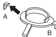
5. Setzen Sie die Fußuntersetzer wie auf der Skizze gezeigt bündig an Vorder- und Seitenkante des Waschautomats und drücken Sie die Untersetzer dann fest. Brechen Sie die Endstücke ab.
