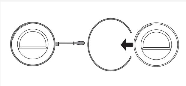
**7** Retirez provisoirement le joint du hublot.
