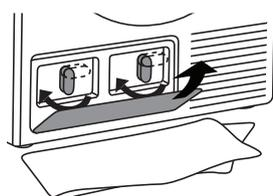
**8** Remettez en place le couvercle intérieur et tournez les loqueteaux dans le sens des aiguilles d'une montre jusqu'à ce qu'ils soient en position verticale.
