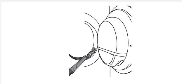
Les ouvertures dans la partie basse de l'encadrement du hublot doivent être nettoyées de temps en temps avec un aspirateur.
