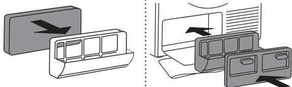
**7** Remontez le filtre en mousse et le logement du filtre.
