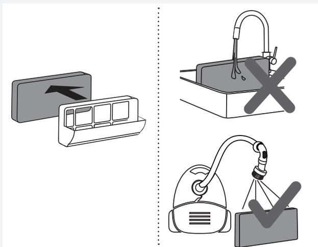
**4** Retirez le filtre en mousse du boîtier. Nettoyez-le à l'aide d'un aspirateur et d'une brosse douce. Remplacez le filtre en mousse propre dans le boîtier.
