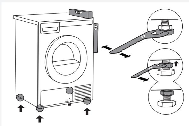
Installez le sèche-linge de façon à ce qu'il soit stable. Utilisez un niveau à bulles pour mettre l'appareil à niveau dans le sens longitudinal et le sens transversal en tournant les pieds réglables avec une clé plate de 22 mm (ajustement en hauteur de 15 mm au maximum). Puis serrez fermement les contre-écrous avec une clé plate de 17 mm en les tournant vers le fond du lave-linge ↑.
