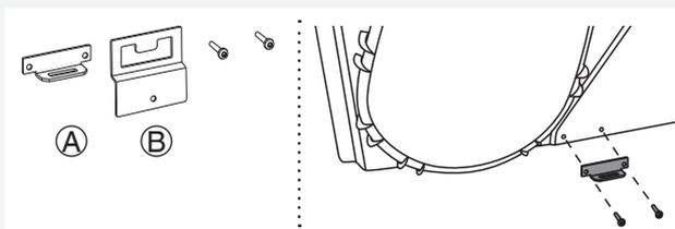
**1** Le dispositif antibasculement se compose de deux pièces en métal (A + B). Fixez la pièce A à l'arrière du sèche-linge avec deux vis.
