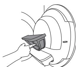
**3** Verwijder van het filter voorzichtig alle aanslag, vezels en draadjes.
