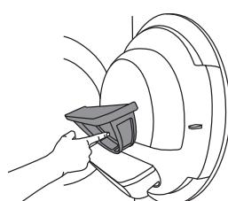
**3** Streichen Sie mit der Hand leicht über das Flusensieb, um Faserreste und Flusen zu entfernen.
