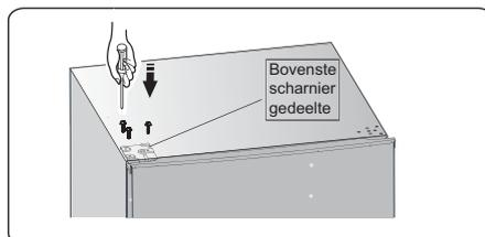
16. De schroefgat deksel in de rechterbovenhoek van de koelkast installeren. Installeer de bovenste scharnierkap (in de plastic zak verpakt) aan de linkerkant. De andere bovenste scharnierkap in de plastic zak verpakken.
