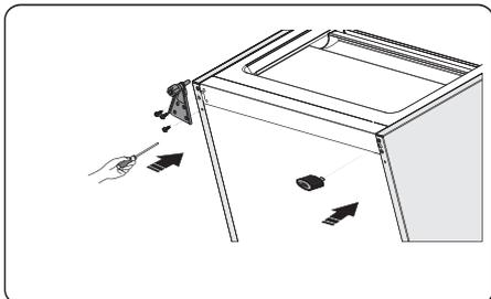
12. De onderste deur naar de juist plaats overbrengen, het onderste scharnierdeel aanpassen, plaats de scharnieras in het onderste opening van de onderste deur, vervolgens vastdraaien met de schroeven.
