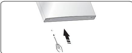
7. De twee speciale zelftappende flensschroeven losdraaien die worden gebruikt voor het bevestigen van het middelste scharnierdeel, vervolgens het middelste scharnierdeel dat de onderste deur vasthoudt verwijderen. **OPMERKING:** Bij het verwijderen van de deur, let op de borgring(en) tussen het midden scharnier aangezien deze op de bodem van de deur kan vallen. Niet loslaten.
