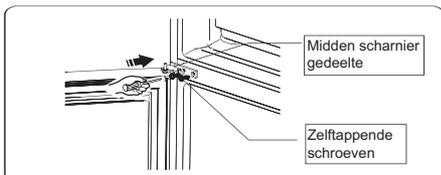
14. De bovenste deur naar de juiste positie overbrengen. De deur waterpas zetten, de middelste scharnieras in het onderste opening van de bovenste deur vastmaken.
