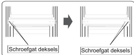
10. Leg de koelkast op zachte schuimverpakking of soortgelijk materiaal. Verwijder beide verstelbare voetjes aan de onderkant, en verwijder het onderste scharniergedeelte door de speciale flensschroeven los te schroeven.
