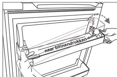
Teneerstelt u de linkerkant van het deurschap naar boven, en zorgt ervoor dat de inkeping aan de deur is bevestigd. Vervolgens drukt u de rechterzijde naar binnen, drukt het naar beneden naar de rechterkant.
