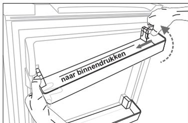
Druk de rechterzijde van het deurschap naar binnen, terwijl u de linkerkant vasthoudt. Wanneer de inkeping van de plank is losgemaakt vanuit de koelkastdeur, verwijdert u het rek schuin naar boven.
