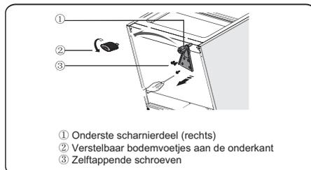
11. Het onderste scharnierdeel aan de linkerkant vervangen en vervolgens bevestigen met de speciale flens zelftappende schroeven. Verplaats de verstelbare bodemvoetjes naar de andere zijde en deze bevestigen.
