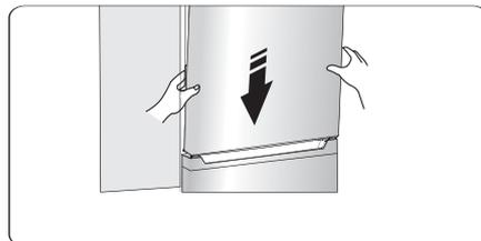
15. Het bovenste scharnierdeel overbrengen en de bovenste scharnieras in het bovenste opening van de bovenste deur bevestigingen, en de positie van de bovenste deur aanpassen (Ondersteun alsjeblift de bovenste deur met uw hand wanneer u het uitvoert), het bovenste scharnierdeel met de speciale flens zelftappende schroeven vastdraaien.
