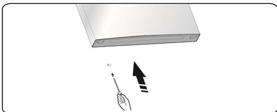
7. Dévisser les deux vis autotaraudeuses spéciales à bride qui servent à fixer la partie centrale de la charnière, puis retirer la partie centrale qui maintient la porte inférieure en place.
