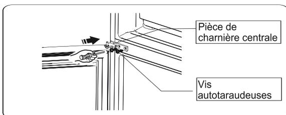
14. Transférez la porte supérieure à la position appropriée. Fixez le niveau de la porte, faites rentrer l'axe de la charnière centrale dans le trou inférieur de la porte supérieure.
