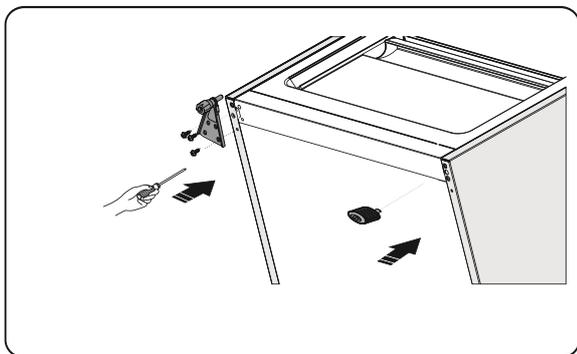
12. Transférez la porte inférieure sur la position de propriété, ajustez la partie inférieure de la charnière, faites rentrer l'axe de charnière dans le trou inférieur de la porte inférieure, puis serrez les boulons.
