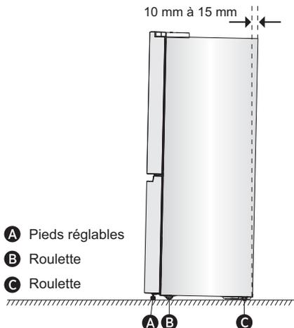
**REMARQUE:** Le fait d'avoir quelqu'un pour pousser le haut du réfrigérateur réduit un peu le poids au niveau des pieds de mise à niveau. Il est ainsi plus facile de tourner les pieds réglables.
