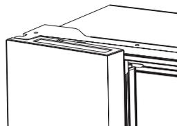
**REMARQUE:** Avant de fermer la porte gauche, rassurez-vous que le meneau s'est replié vers l'intérieur. Si le meneau se replie vers l'extérieur, il peut être endommagé lorsque vous essayez de fermer la porte.
