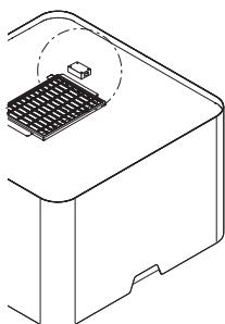
1. Trennen Sie die Abzugshaube von der Stromversorgung. Schalten Sie dazu die Hauptsicherung aus, oder entfernen Sie die Sicherung (0). Die Abzugshaube kann auch über den EIN/AUS-Schalter an der Oberseite von der Stromversorgung getrennt werden (falls vorhanden).
