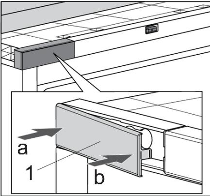
8. Plaats de afdekking deksel van de bovenste scharnierbehuizing (1) terug. Duw eerst in de richting van pijl "a" en vervolgens pijl "b".
