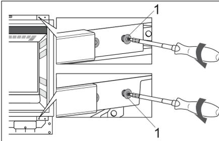
6. Lösen Sie die Scharnierschrauben (1) oben und unten. Legen Sie sie beiseite, da Sie sie später benötigen werden.
