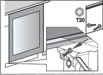
7. Fixez l'appareil à l'élément de cuisine adjacent en bas, sur le côté opposé de la charnière.
