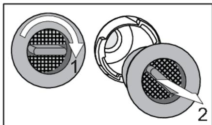
Pour remplacer le filtre à air :
