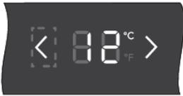
Durch Drücken der Pfeiltasten ändert sich die Solltemperatur im „T“-Display. Mit jedem Drücken ändert sich die Solltemperatur um 1 °C nach oben oder unten. Die Solltemperatur wird 2 Sekunden nach dem letzten Drücken der Temp-Up- oder Temp-Down-Taste gespeichert.
