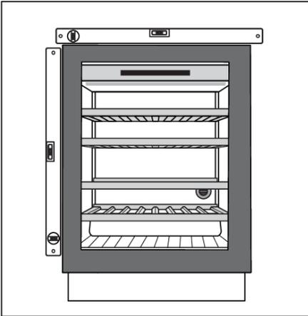
2. Das Gerät muss horizontal und vertikal ausgerichtet sein, da es sich sonst verformen kann und es nicht möglich ist, die Tür ordnungsgemäß zu schließen.
