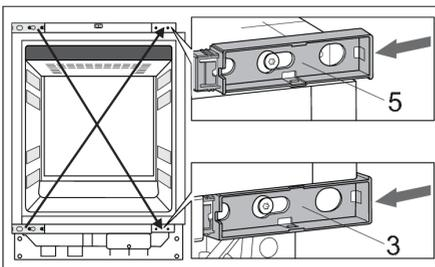
9. Neem de reeds verwijderde scharnierbehuizingen (3, 5) en schuif ze diagonaal op hun plaats.
