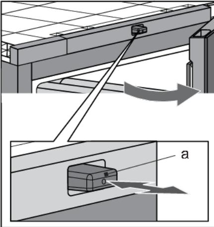
Der Druckstift (a) des Mechanismus bewegt sich nach vorne und die Tür öffnet sich um ca. 6 cm. Dann können Sie die Tür vollständig öffnen. Wenn Sie die Tür nicht vollständig öffnen, wird sie automatisch geschlossen. Der Soft-Close-Mechanismus schließt die Tür sanft.
