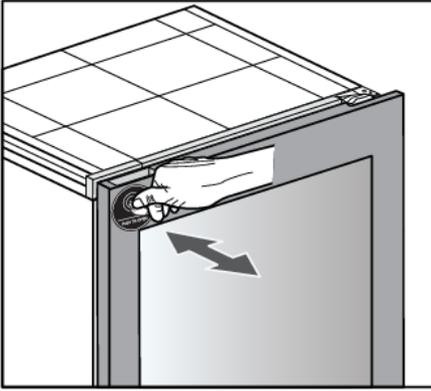
Um die Tür zu öffnen, schieben Sie sie oben links leicht nach innen und lassen Sie sie dann los.
