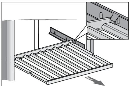
De plank kan ook gedeeltelijk uit het apparaat worden getrokken. De blokken op de kunststof plankdragers beschermen de plank tegen volledig uitschuiven en uittrekken, waardoor deze uit het apparaat zou kunnen vallen.
