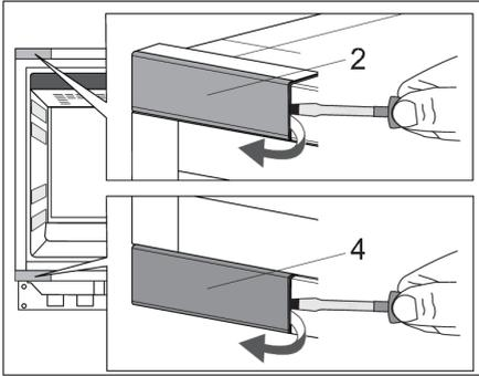
4. Verwijder voorzichtig de bovenste (2) en onderste (4) afdekkingen van de scharnierbehuizing met behulp van een platte schroevendraaier. Leg ze apart want u hebt deze later weer nodig.
