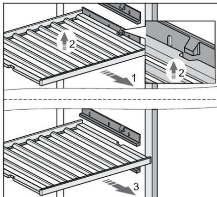
Pour retirer une clayette de l'appareil électroménager, tirez-la partiellement vers vous (1) jusqu'à ce que les deux rainures de la clayette et le bloc des supports de clayette en plastique soient alignés. Ensuite, soulevez la clayette (2) et retirez-la de l'appareil (3). Veillez à ne pas endommager le joint de la porte.
