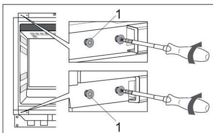
8. Fixez partiellement les vis (1) dans les trous en haut et en bas sur le côté gauche du boîtier.
