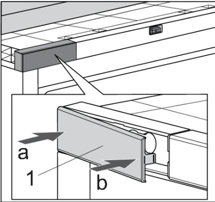
8. Bringen Sie die obere Abdeckung des Scharniergehäuses (1) wieder an. Drücken Sie zuerst in Richtung des Pfeils „a“ und dann des Pfeils „b“.
