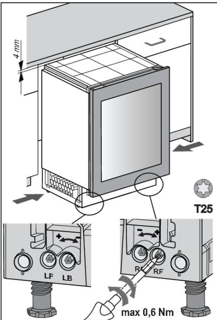
1. Bevor Sie das Gerät in die Öffnung schieben, stellen Sie die Höhe des Geräts auf 4 mm unter der Öffnung ein. Dies kann durch Drehen der verstellbaren FüÙe erfolgen: LF - links vorne , LB - links hinten, RF - rechts vorne, RB - rechts hinten.
