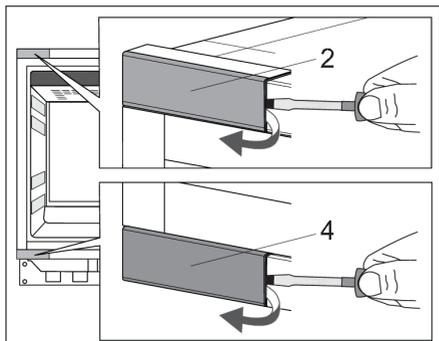
4. Retirez délicatement les couvercles des boîtiers de charnière supérieure (2) et inférieure (4) à l'aide d'un tournevis à tête plate. Mettez-les de côté, car vous en aurez besoin plus tard.
