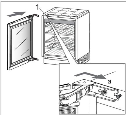
12. Hängen Sie die Tür oben und unten an die Schrauben (1) und schieben Sie sie in Pfeilrichtung (a).
