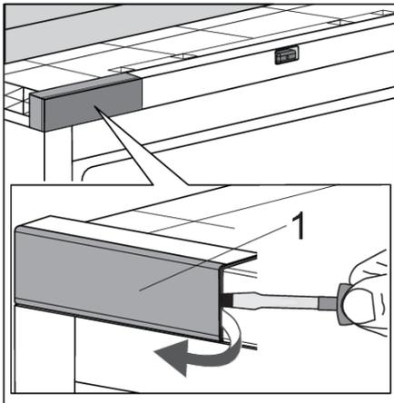
3. Ouvrez la porte de l'appareil. Retirez délicatement le couvercle supérieur du boîtier de la charnière supérieure (1) à l'aide d'un tournevis à tête plate. Mettez-le de côté, car vous en aurez besoin plus tard. Si vous avez changé la direction d'ouverture de la porte, commencez dans le coin supérieur droit.
