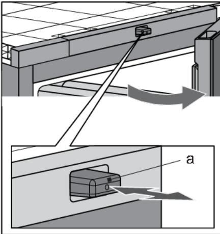
Le poussoir du mécanisme (a) s'enclenche et la porte s'ouvre d'environ 6 cm. Ensuite, vous pouvez ouvrir complètement la porte. Si vous n'ouvrez pas complètement la porte, elle se ferme automatiquement. Le mécanisme de fermeture douce ferme délicatement la porte.
