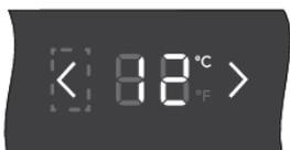
Door op de pijltoetsen te drukken, verandert de referentietemperatuur op display 'T'. Met elke druk op de knop verandert de referentietemperatuur met 1°C omhoog of omlaag. De referentietemperatuur wordt 2 seconden na de laatste druk op de pijltoets temp-omhoog of temp-omlaag opgeslagen.
