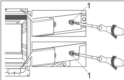
6. Verwijder de twee scharnierschroeven (1) aan de boven- en onderkant. Leg ze apart want u hebt deze later weer nodig.
