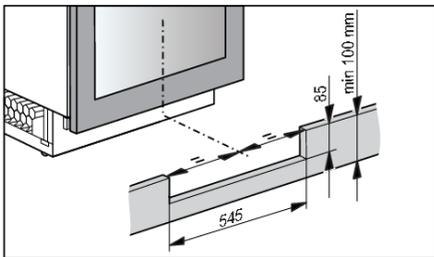
15. Maak de plint klaar. De uitsparing in de plint voor het ventilatierooster moet in het midden van het apparaat worden aangebracht. Alleen zo is een goede werking gewaarborgd.
