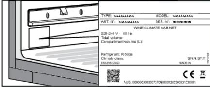
Placez l'appareil dans un lieu sec et bien ventilé. La plage de températures ambiantes autorisée pour l'appareil dépend de sa classe climatique qui est indiquée sur la plaque signalétique.
