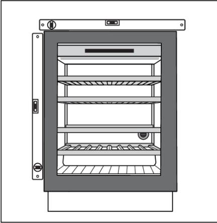
2. Het apparaat moet horizontaal en verticaal worden uitgelijnd, anders kan het vervormd raken en kan de deur niet goed worden gesloten.
