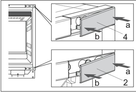
10. Nehmen Sie die bereits entfernten oberen (2) und unteren (4) Scharnierabdeckungen und stellen Sie sie auf die diagonale Position, aus der sie stammen. Drücken Sie zuerst in Richtung des Pfeils „a“ und dann des Pfeils „b“.
