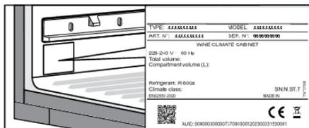
Stellen Sie das Gerät in einem trockenen und gut belüfteten Raum auf. Der zulässige Umgebungstemperaturbereich für das Gerät hängt von der Klimaklasse des Geräts ab, die auf dem Typenschild angegeben ist.
