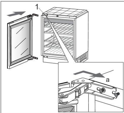
12. Hang de deur aan de schroeven (1) aan de boven- en onderkant en schuif deze in de richting van de pijl (a).
