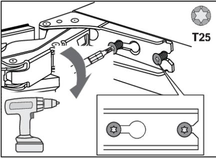
13. Draai de schroeven vast. De schroeven moeten worden aangedraaid met een koppel van 6,2 Nm.
