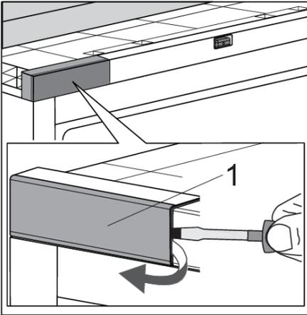
3. Open de deur van het apparaat. Verwijder voorzichtig de afdekking van de bovenste scharnierbehuizing (1) met behulp van een platte schroevendraaier. Leg deze opzij want u hebt deze later weer nodig. Als u de openingsrichting van de deur hebt gewijzigd, begin dan in de rechterbovenhoek.
