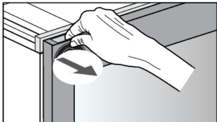
Im Falle eines Stromausfalls, wenn der Push-to-Open-Türmechanismus nicht funktioniert, ermöglicht der verborgene Griff das Öffnen der Tür.
