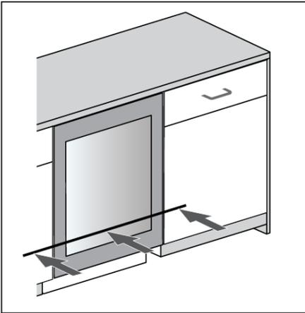
6. Fixez l'appareil à l'élément de cuisine adjacent – d'abord dans le coin supérieur gauche.
