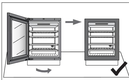
4. L'appareil et la porte doivent être parallèles.
