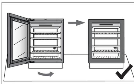
14. Fermez la porte et assurez-vous qu'elle est bien alignée avec le châssis. Le côté du châssis et le bord de la porte doivent être parallèles.
