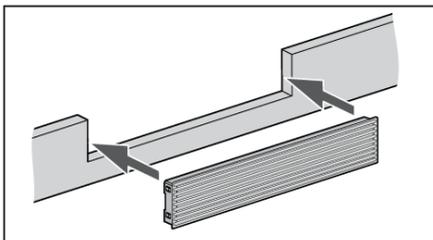
16. Montieren Sie das Lüftungsgitter in das Holzsockelbrett.
