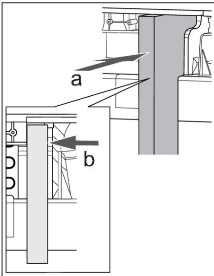
11. Schieben Sie den Schaumstoff-Luftstromteiler in Richtung der Pfeile "a" und "b".
