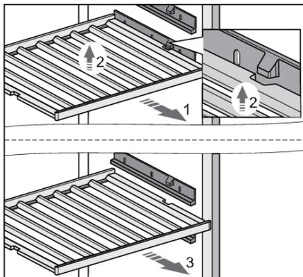
Om een plank uit het apparaat te nemen, trekt u deze gedeeltelijk naar u toe (1) totdat de twee groeven op de plank en het blok op de kunststof plankdragers zijn uitgelijnd. Til vervolgens de plank (2) op en trek deze uit het apparaat (3). Zorg ervoor dat u de deurpakking niet beschadigt.
