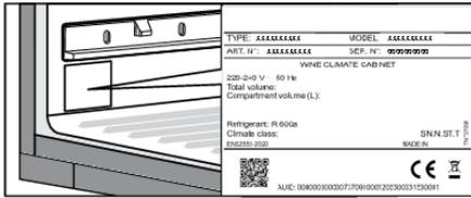
Plaats het apparaat in een droge en goed geventileerde ruimte. De toegestane omgevingstemperatuur voor het apparaat is afhankelijk van de klimaatklasse van het apparaat, die op het typeplaatje staat aangegeven.
