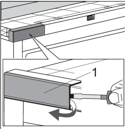
3. Öffnen Sie die Gerätetür. Entfernen Sie vorsichtig die obere Scharnierabdeckung (1) mit Hilfe eines Schlitzschraubendrehers. Legen Sie sie beiseite, wie Sie sie später brauchen werden. Falls Sie die Türöffnungsrichtung geändert haben, beginnen Sie in der oberen rechten Ecke.
