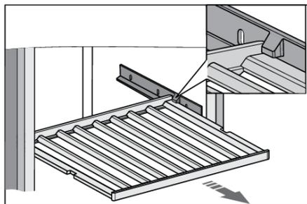
La clayette peut également être partiellement retirée de l'appareil. Les blocs sur les supports de clayette en plastique empêchent la clayette de se déployer complètement et de sortir, ce qui pourrait la faire tomber de l'appareil.
