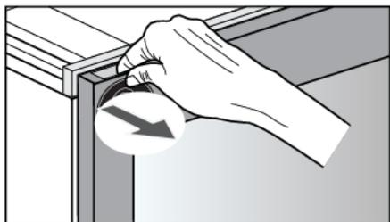
In geval van stroomuitval, wanneer het push-to-open deurmechanisme niet werkt, kunt u met de verborgen handgreep de deur openen.
