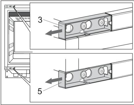
5. Entfernen Sie das obere (3) und das untere (5) Scharniergehäuse. Legen Sie sie beiseite, da Sie sie später benötigen werden.
