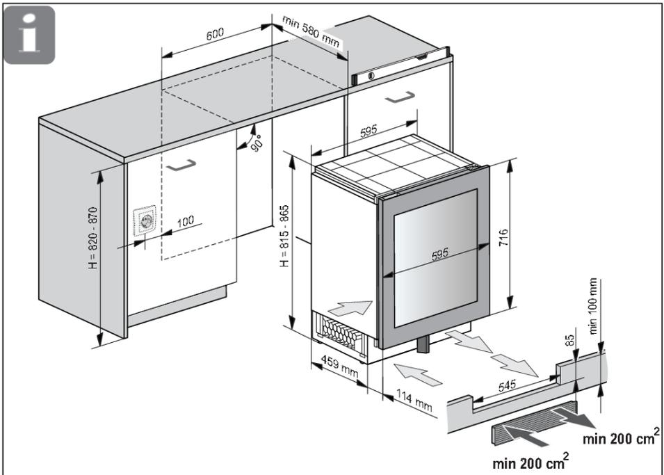
Die Belüftung des Gerätes erfolgt durch die Schlitze im Sockel. Diese dürfen nicht abgedeckt werden. Darüber hinaus muss Staub regelmäßig aus den Schlitzen gereinigt werden.
