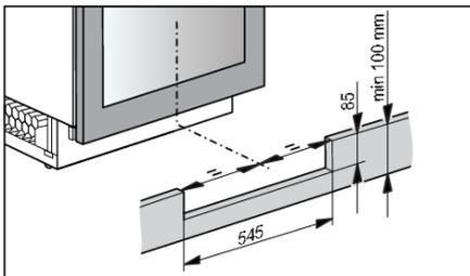
15. Bereiten Sie das Sockelbrett vor. Die Aussparung im Sockelbrett für das Lüftungsgitter muss mit dem Gerät zentriert werden. Nur so kann der ordnungsgemäße Betrieb des Gerätes gewährleistet werden.
