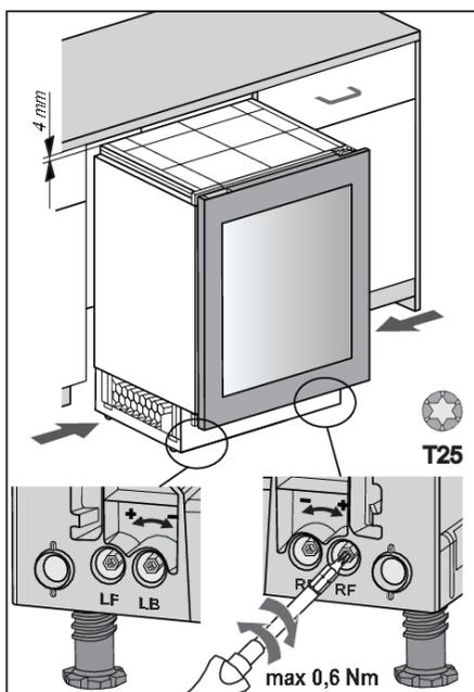
1. Voordat u het apparaat in de nis schuift, stelt u de hoogte van het apparaat in op 4 mm minder dan de bovenkant van de nis. Dit doet u door aan de stelvoetjes te draaien: LF - linksvoor, LB - linksachter, RF - rechtsvoor, RB - rechtsachter.
