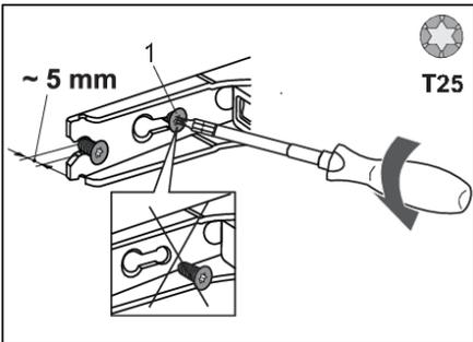
2. Draai de scharnierschroeven (1) aan de boven- en onderkant iets (max. 5 mm) los. Draai de schroeven niet helemaal los. Op deze manier blijft de deur in contact met de behuizing.
