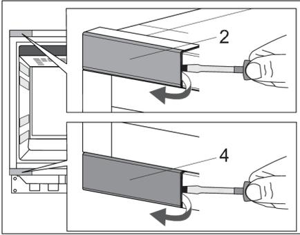
4. Entfernen Sie vorsichtig die obere (2) und untere (4) Scharnierabdeckung mit Hilfe eines Schlitzschraubendrehers. Legen Sie sie beiseite, da Sie sie später benötigen werden.
