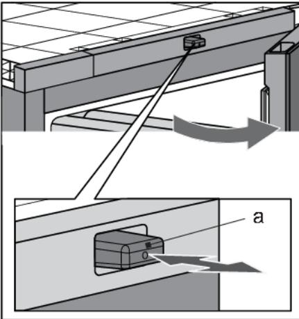
De drukpin (a) van het mechanisme beweegt naar voren en de deur gaat ongeveer 6 cm open. Vervolgens kunt u de deur volledig open trekken. Als u de deur niet open doet, gaat deze automatisch weer dicht. Het soft-close mechanisme sluit de deur zachtjes.
