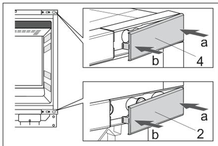
10. Prenez les couvercles de boîtiers de charnière supérieure (2) et inférieure (4) déjà retirés et placez-les en suivant un schéma en diagonal.
