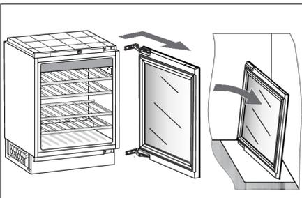
3. Verwijder de deur, compleet met de scharnieren, door deze in de richting van de pijl te bewegen. Zet de deur voorzichtig op de daarvoor voorbereide plek.
