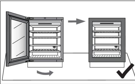
14. Sluit de deur en zorg ervoor dat deze is uitgelijnd met de behuizing. De behuizingzijde en de rand van de deur moeten parallel lopen.
