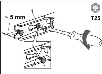
2. Lösen Sie die Scharnierschrauben (1) oben und unten teilweise (nicht mehr als 5 mm). Lösen Sie die Schrauben nicht vollständig. Auf diese Weise bleibt die Tür in Kontakt mit dem Gehäuse.
