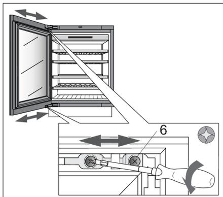
2. Dévissez les vis partiellement (6) en haut et en bas. Ne les dévissez pas complètement ! Alignez la porte sur le côté et resserrez les vis.
