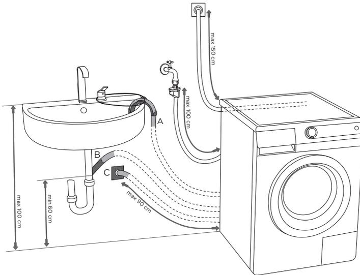
**A** Vous pouvez placer le flexible de vidange sur le rebord d'un évier, d'un lavabo, ou d'une baignoire. Fixez le tuyau à l'aide d'une ficelle que vous passerez dans l'œillet du coude pour éviter qu'il tombe par terre.
