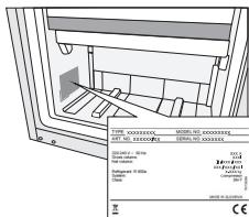
Het typeplaatje bevindt zich aan de binnenzijde van het apparaat (zie afbeelding). Op dit plaatje staat informatie over spanning, bruto- en netto-inhoud, type en hoeveelheid koelmiddel, en informatie over de klimaatklasse.
