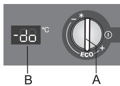
Falls die Gerätetür länger als 1 Minute geöffnet ist, erscheint auf dem Display **B** das Wort „do“.
