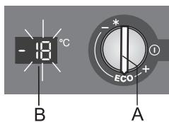
Un signal est émis quand la température de l'appareil est trop élevée. La température réglée indiquée sur l'afficheur et le voyant LED, si existant, clignotent.
