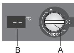
**Inschakelen:** Om het apparaat in te schakelen: draai knop **A** rechtsom.
