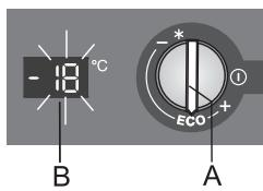
Bei zu hoher Temperatur im Geräteinneren ertönt ein akustischer Alarm. Auf dem Display wird die Solltemperatur angezeigt und ein LED-Indikatorlämpchen blinkt, falls es eingebaut ist.
