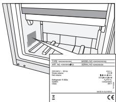
La plaque signalétique est apposée à l'intérieur de l'appareil. Elle indique la tension, le poids brut et net, le type et la quantité de réfrigérant et les classes climatiques. Si elle n'est pas dans la langue de votre choix ou celle de votre pays, collez par-dessus l'étiquette adhésive jointe.
