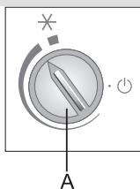
**Mise en marche :** Tournez le bouton du thermostat A dans le sens des aiguilles d'une montre et positionnez le curseur sur la partie large du symbole.
