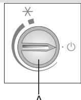
**Mise à l'arrêt :** Tournez le bouton A jusqu'à aligner la flèche sur le symbole ⏻ (l'appareil reste alimenté, c'est-à-dire qu'il reste sous tension).
