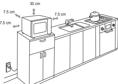
Decken Sie die Lüftungsschlitzte nicht ab.
