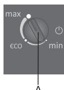
Faites pivoter le thermostat (A) vers la droite jusqu'au maximum.
