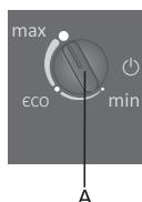
Drehen Sie den Thermostatkopf (A) im Uhrzeigersinn auf die Höchststufe.
