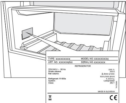
Das Typenschild mit den Grunddaten des Geräts befindet sich im Geräteinneren.
