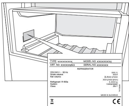
Das Typenschild mit den Grunddaten des Geräts befindet sich im Geräteinneren. Es enthält Informationen über die Spannung, das Brutto- und Netto-Volumen, die Art und die Menge des Kältemittels sowie Informationen über die Klimaklasse. Falls das Typenschild nicht in Ihrer Sprache ist, überkleben Sie es mit dem entsprechenden beigelegten Etikett.
