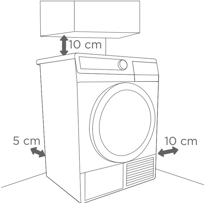
Die Entlüftungsschlitze und die Öffnung an der vorderen bzw. hinteren Gerätewand des Wäschetrockners müssen freigehalten werden.
