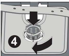
Um die Filterkombination herauszunehmen und zu reinigen, müssen Sie sie entgegengesetzt zum Uhrzeigersinn (nach links) drehen und dann herausnehmen. **1**
