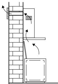
2. Version recyclage. Les particules de graisse et les odeurs contenues dans les vapeurs de cuisson sont filtrées. L'air aspiré n'est pas évacué, mais renvoyé dans la cuisine. Il convient de placer un filtre à charbon actif dans la hotte.
