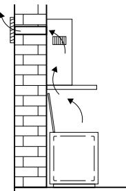
2. Als recirculatie afzuigkap. De vetdeeltjes en de geur uit de aangezogen kookdampen worden gefilterd. De aangezogen lucht wordt niet afgevoerd maar teruggeblazen in de keuken.
