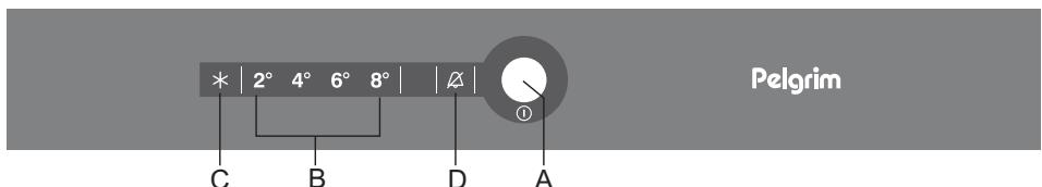
**A Touche Marche/Arrêt de l'appareil et touche de réglage de la température et des fonctions complémentaires**
