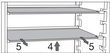
Pour enlever une clayette du réfrigérateur, soulevez-la au niveau de la partie avant (4). Saisissez la partie arrière de la clayette et tirez-la pour la sortir de l'appareil (5).
