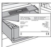
La plaque signalétique est apposée à l'intérieur de l'appareil.
