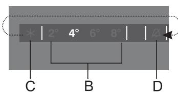
Les chiffres 2, 4, 6 et 8 indiquent la température en degrés Celsius (°C) dans le compartiment réfrigérateur.
