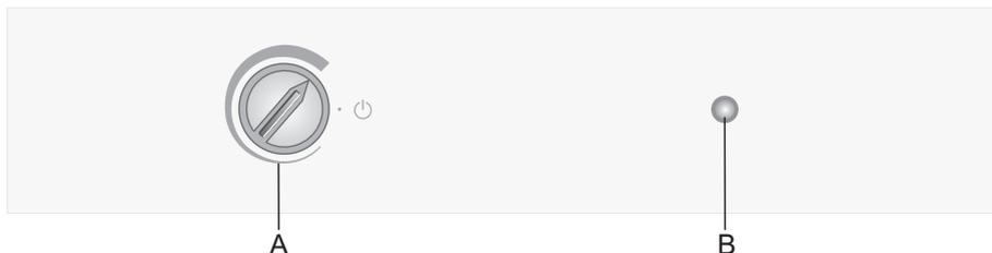
**A** Bouton du thermostat : réglage de la température et Marche/Arrêt
