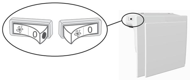
*Lorsque le ventilateur et l'ioniseur sont en marche, un point rouge est visible sur l'interrupteur.*
