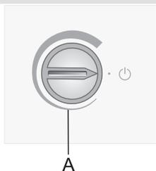
Pour mettre l'appareil en marche, tournez le bouton du thermostat **A** dans le sens des aiguilles d'une montre.
