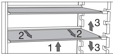
Die Böden sind aus Sicherheitsglas hergestellt. Um einen Boden auf eine andere Höhe einzustellen, Vorderkante anheben (1). Hinterkante anfassen und Boden sanft nach vorn ziehen (2). Boden an der gewünschten Position einschieben (3).
