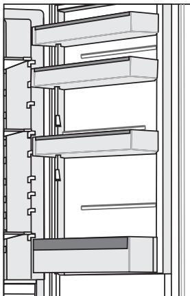
De deurvakken zijn in hoogte verstelbaar. Til het vak uit de groef en plaats het in de gewenste positie. De maximale belasting van elk vak is 5 kg. Het onderste deurvak is geschikt voor flessen.
