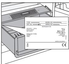
Das Typenschild mit den Grunddaten des Geräts befindet sich im Geräteinneren. Es enthält Informationen über die Spannung, das Brutto- und Netto-Volumen, die Art und die Menge des Kältemittels sowie Informationen über die Klimaklasse. Falls das Typenschild nicht in Ihrer Sprache ist, überkleben Sie es mit dem entsprechenden beigelegten Etikett.
