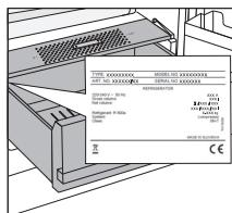
La plaque signalétique est apposée à l'intérieur de l'appareil.
