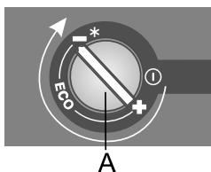
Si la température de la pièce dans laquelle l'appareil est installé est inférieure à 16°C, nous vous recommandons de régler le bouton **A** vers l'icône **-**.
