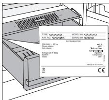
Het typeplaatje bevindt zich aan de binnenzijde van het apparaat (zie afbeelding). Op dit plaatje staat informatie over spanning, bruto- en netto-inhoud, type en hoeveelheid koelmiddel, en informatie over de klimaatklasse.
