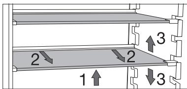
Les clayettes sont en verre de sécurité. Pour changer la hauteur d'une clayette, soulevez-la au niveau de la partie avant (1). Saisissez la partie arrière de la clayette et tirez-la légèrement vers l'avant (2). Déplacez la clayette à un niveau supérieur ou inférieur (3).
