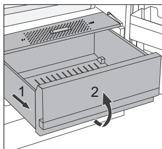
Um das Fach heraus zu ziehen, ziehen Sie das Fach bis zum Anschlag heraus (1). Heben Sie es vorne etwas an, dann können Sie es vollständig herausziehen (2).
