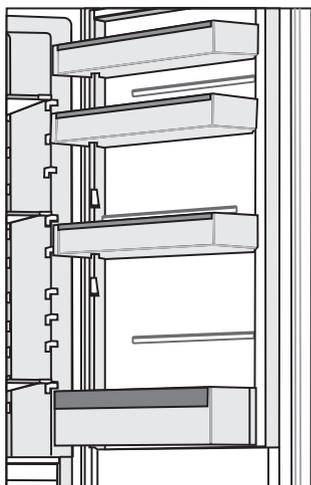
De deurbakken zijn in hoogte verstelbaar. Til de bak uit de groef en plaats het in de gewenste positie.
