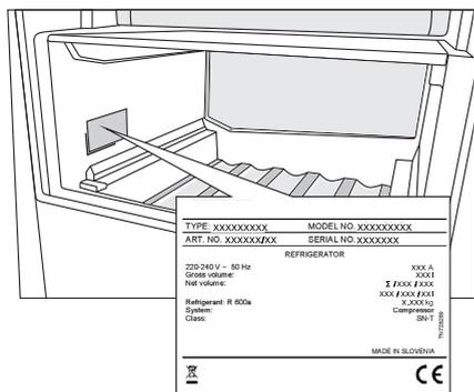
Het typeplaatje bevindt zich aan de binnenzijde van het apparaat (zie afbeelding).
