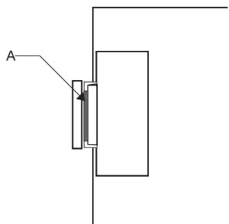
De “deur open” indicator (A) op de sluiting van de vriesvakdeur geeft aan of de deur goed gesloten is.
