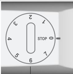
Pour mettre l'appareil à l'arrêt, tournez le bouton sur la position **STOP (0)**.
