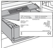
Das Typenschild mit den Grunddaten des Geräts befindet sich im Geräteinneren. Es enthält Informationen über die Spannung, das Brutto- und Netto-Volumen, die Art und die Menge des Kältemittels sowie Informationen über die Klimaklasse. Falls das Typenschild nicht in Ihrer Sprache ist, überkleben Sie es mit dem entsprechenden beigelegten Etikett.
