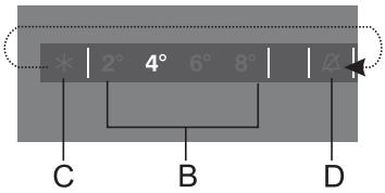
Les chiffres 2, 4, 6 et 8 indiquent la température en degrés Celsius (°C) dans le compartiment réfrigérateur.
