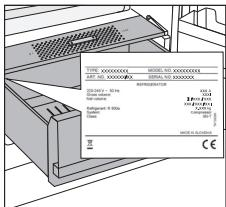
La plaque signalétique est apposée à l'intérieur de l'appareil. Elle indique la tension, le poids brut et net, le type et la quantité de réfrigérant et les classe climatiques. Si elle n'est pas dans la langue de votre choix ou celle de votre pays, collez par-dessus l'étiquette adhésive jointe.
