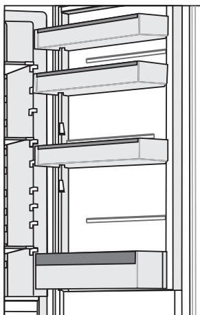
Die Türablagen lassen sich auf verschiedenen Höhen einsetzen. Heben Sie die gewünschte Ablage aus ihrer Nut. Setzen Sie sie an der gewünschten Position wieder ein. Jede Ablage kann maximal 5 kg tragen. In die untere Türablage können Flaschen eingestellt werden.
