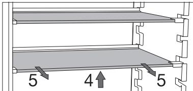
Um einen Boden aus dem Kühlschrank zu entnehmen, Vorderkante anheben (4). Hinterkante anfassen und Boden sanft nach vorn aus dem Gerät herausziehen (5).
