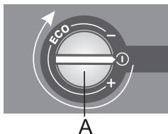
**Inschakelen:** Om het apparaat in te schakelen: draai knop **A** rechtsom.
