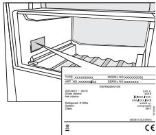
Het typeplaatje bevindt zich aan de binnenzijde van het apparaat (zie afbeelding).
