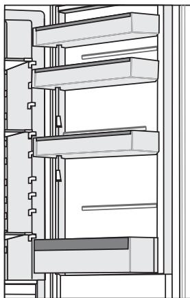
La hauteur des balconnets de porte est réglable. Soulevez le balconnet pour le sortir de la rainure et placez-le à la position souhaitée. Chaque balconnet peut supporter une charge maximale de 5 kg. Le balconnet situé en bas de la porte est adapté pour les bouteilles.
