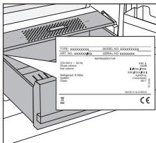
La plaque signalétique est apposée à l'intérieur de l'appareil. Elle indique la tension, le poids brut et net, le type et la quantité de réfrigérant et les classes climatiques. Si elle n'est pas dans la langue de votre choix ou celle de votre pays, collez par-dessus l'étiquette adhésive jointe.
